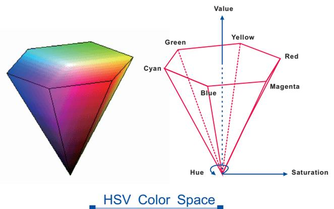
總之，一般螢幕僅為使用RGB彩色空間概念設計。若以24 bit影像作為觀察使用雖足夠，但是如果可以擷取影像品質在30 bit or 36 bit，在後續處理影像上，可以保留足夠數據作為實驗分析用；當為一般自然光影像，應該使用HSL色彩空間調整。如果是螢光圖像，自然而然的HSV將是最佳調整模式。以上概述希望可以讓您也可以輕易調整您的影像至最佳化。
