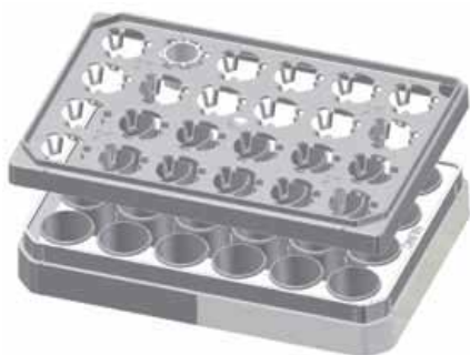
圖1. 利用Carrier Plate調整culture insert於細胞培養盤的高度，方便進行不同細胞培養等實驗設計。
